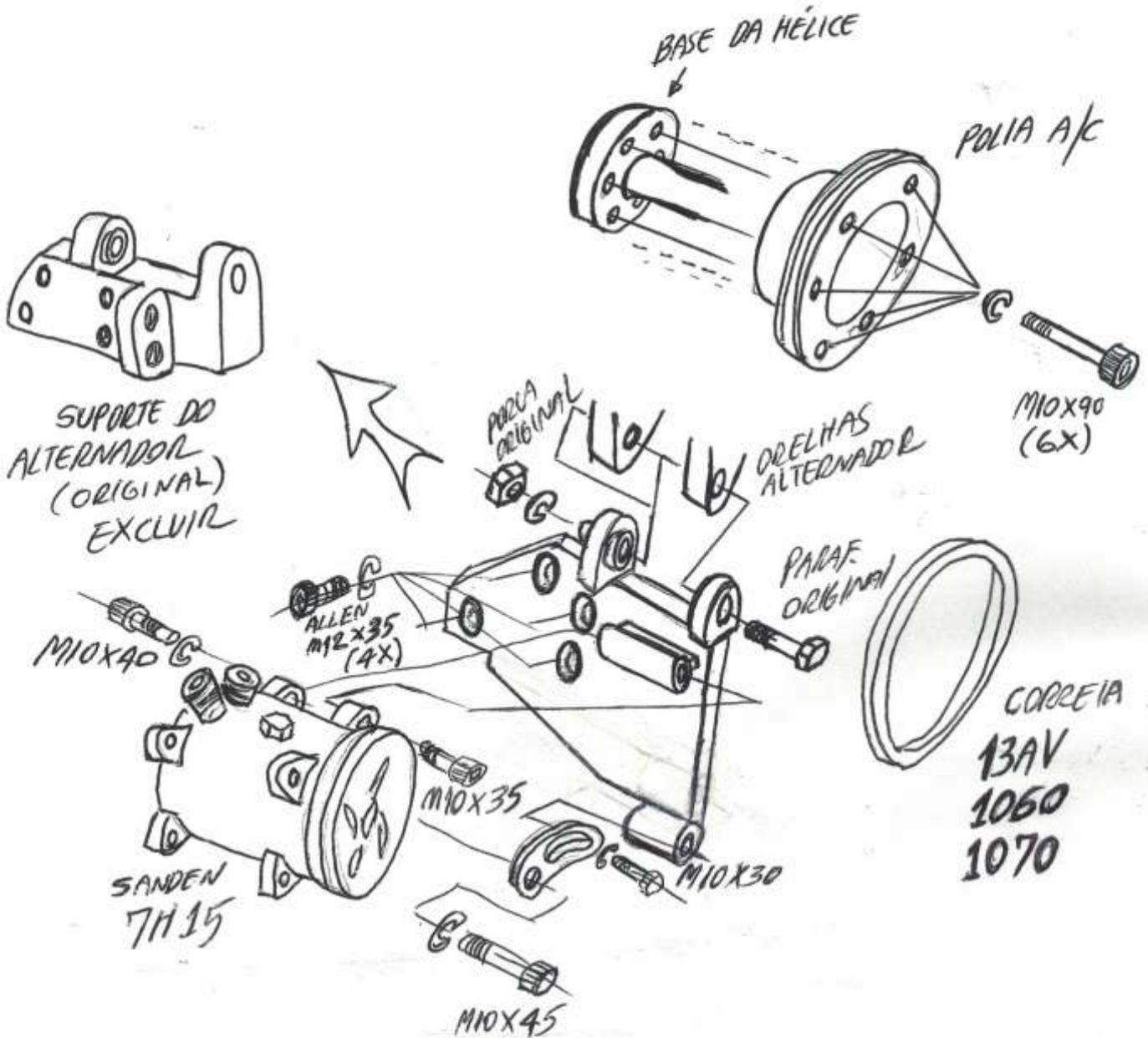
IMPORTANTE: INDISPENSÁVEL A TIPOA DOS PARAFUSOS QUE PRENDEM O SUPORTE DO COMPRESSOR E ALTERNADOR NO BLOCO DO MOTOR
